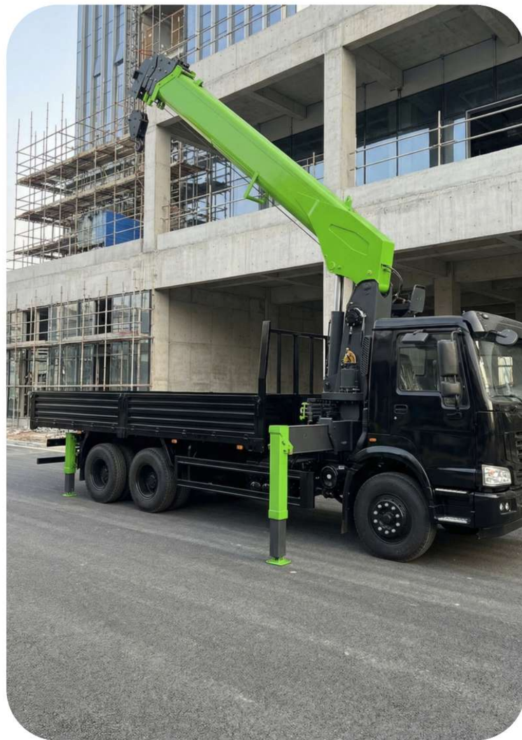
KMGU TC 16 16 тонн / 5,5 метров / 5 секций
