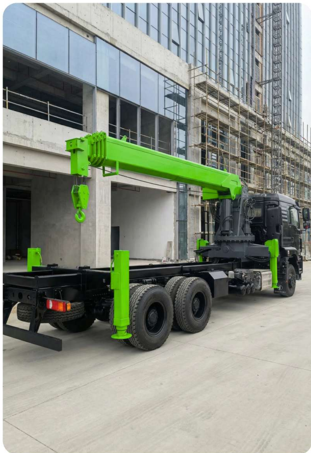
KMGU TC 12 12 тонн / 5 метров / 4 секции
